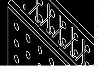
I casseri muro PLASTBAU®-3 vengono prodotti con una larghezza di 120 cm ed un'altezza che può variare, in funzione delle necessità del committente, da 250 cm a 450 cm. I casseri che sono destinati a realizzare strutture verticali esterne, o di cortina, possono essere costruiti con la lastra in EPS esterna più alta di quella interna, ottenendo così una veletta che impedisce i ponti termici , contenendo contemporaneamente il calcestruzzo del cordolo.
