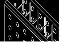
Grazie alla sua rigidità, il pannello cassero **PLASTBAU® 3** non necessità di controventature, In genere è sufficiente un solo puntello ogni pannello con la sola funzione di messa a piombo.
